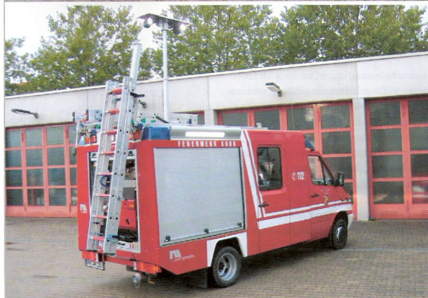
oben: Das TSF-W baute Marte auf einem MB Sprinter 416 CDI auf. (Fotos: J. Wollensak) unten: Anstelle der vierteiligen Steckleiter werden zwei Multifunktionsleitern mitgeführt.
