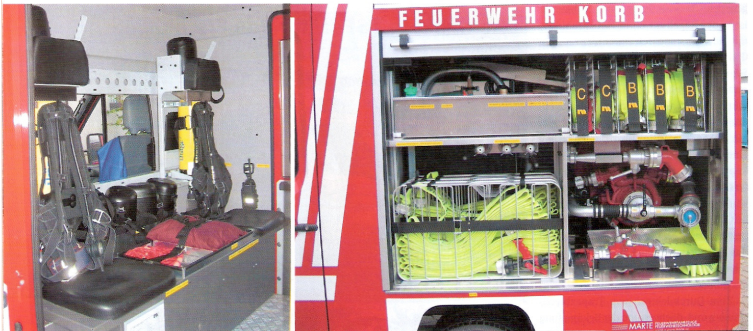
links: Zwei Pressluftatmer im Mannschaftsraum können während der Fahrt angelegt werden. rechts: Blick in den Geräteraum G1
